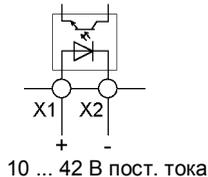
Если на клеммы X1 и X2 подается напряжение постоянного тока, то происходит разгон двигателя с регулируемым временем разгона. Если управляющее напряжение не подается, то происходит останов двигателя с регулируемым временем замедления.
