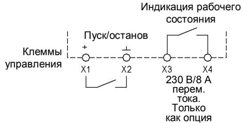
Если контакт замкнут на выводах X1 и X2, двигатель запускается с регулируемым временем разгона. Когда контакт разомкнут, двигатель сбрасывает обороты с регулируемым временем замедления. Двигатель, тем не менее, физически не отключается от питающей сети.
