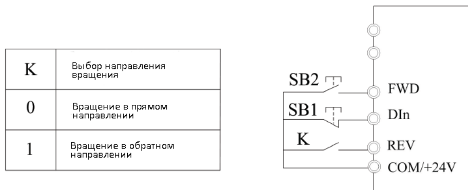
Рисунок 5-10. Трехпроводной режим работы 2
